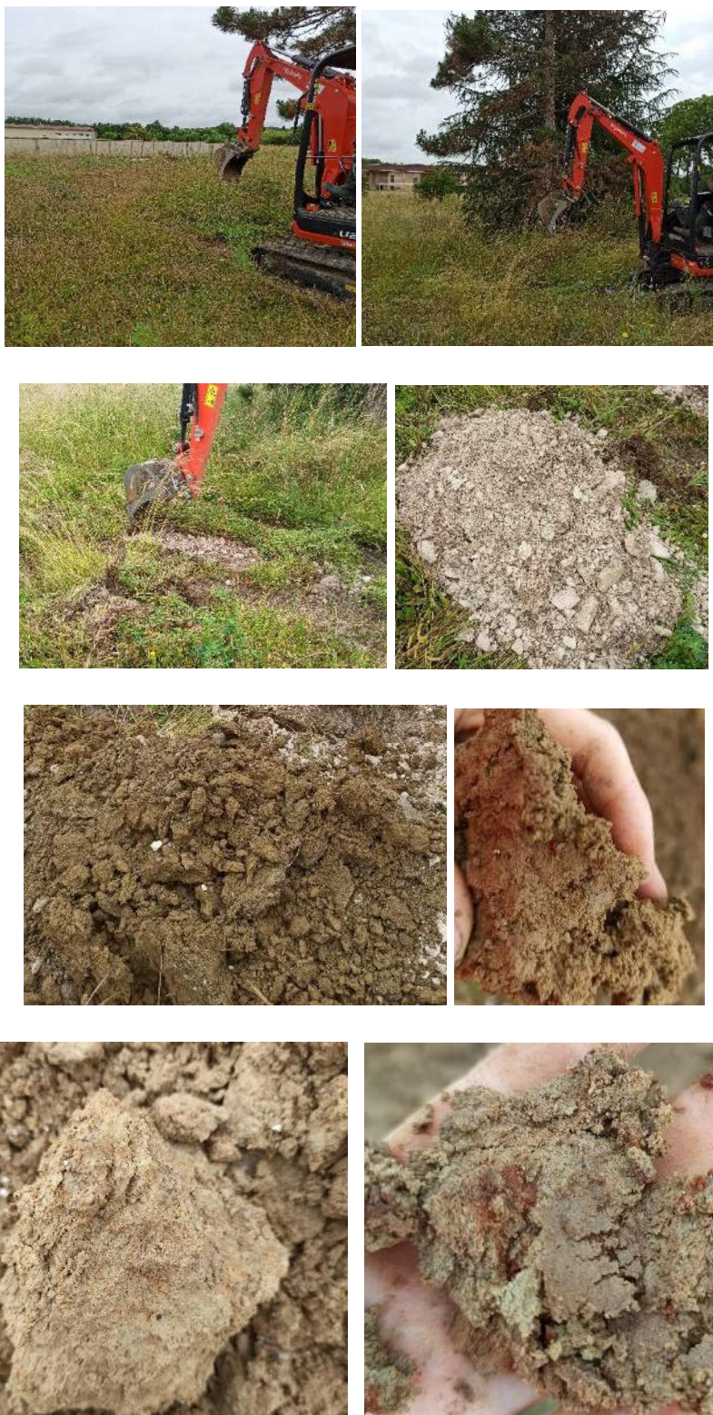
Figure 18 : Photographies de l'implantation du sondage PM5 et du sol rencontré au droit de celui-ci
