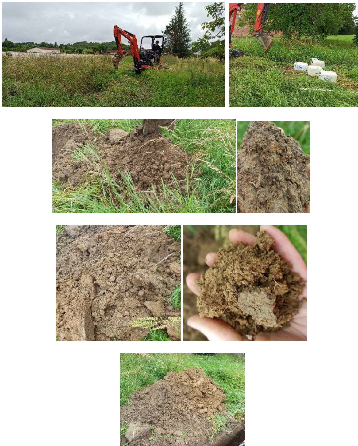
Figure 12 : Photographies de l'implantation du sondage PM2 et du sol rencontré au droit de celui-ci
