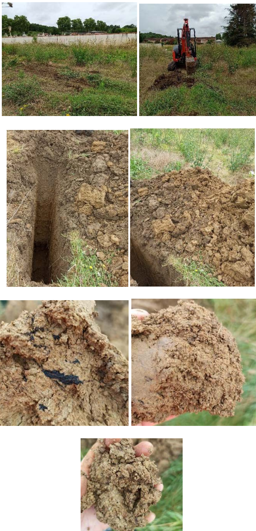
Figure 16 : Photographies de l'implantation du sondage SM4 et du sol rencontré au droit de celui-ci
