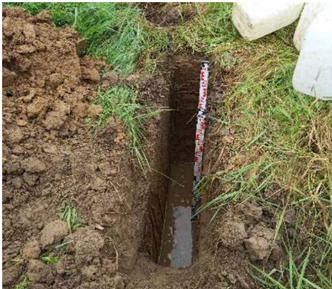
Figure 22 : Test MATSUO sur le sondage PM2
