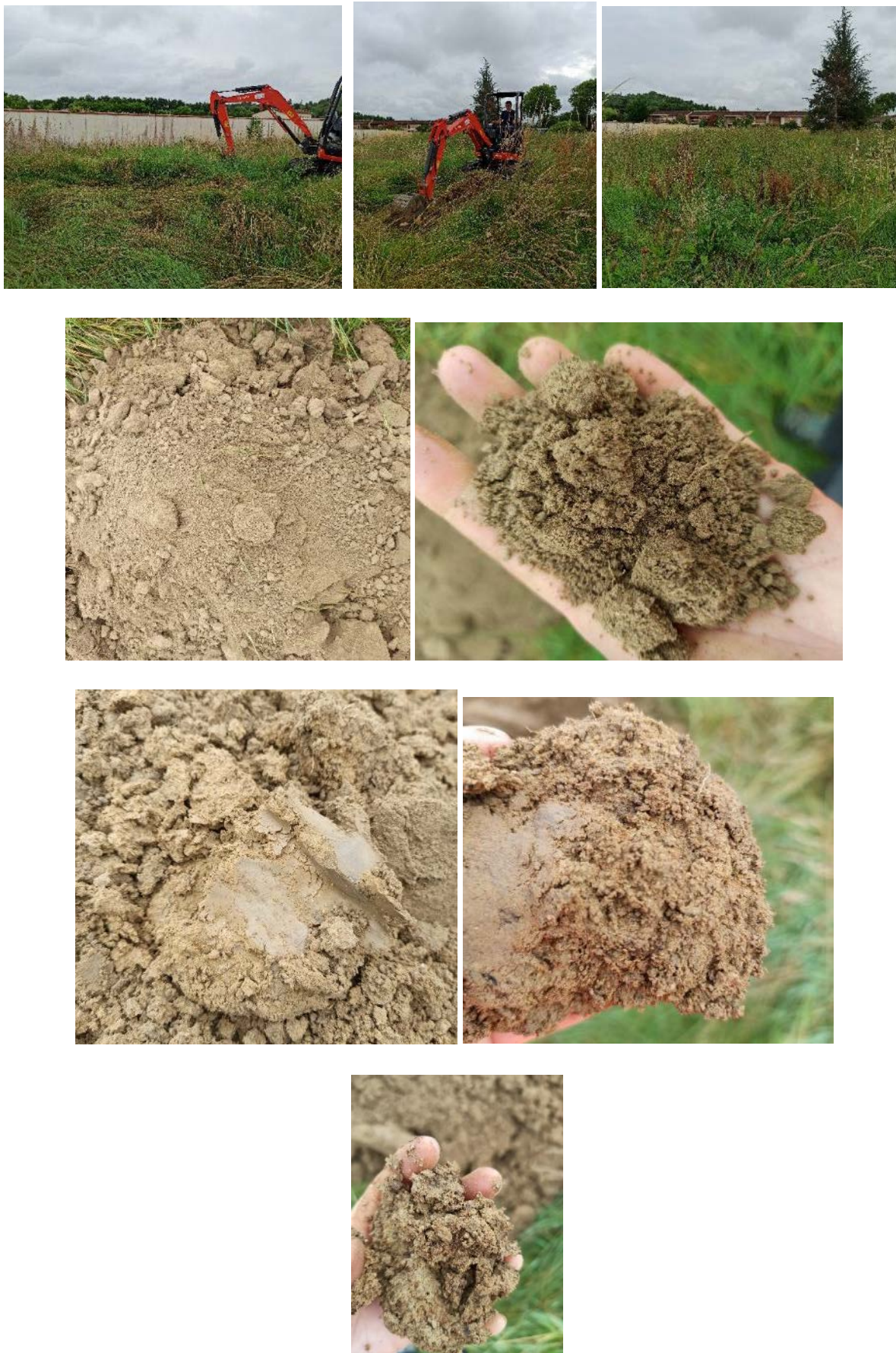
Figure 14 : Photographies de l'implantation du sondage PM3 et du sol rencontré au droit de celui-ci
