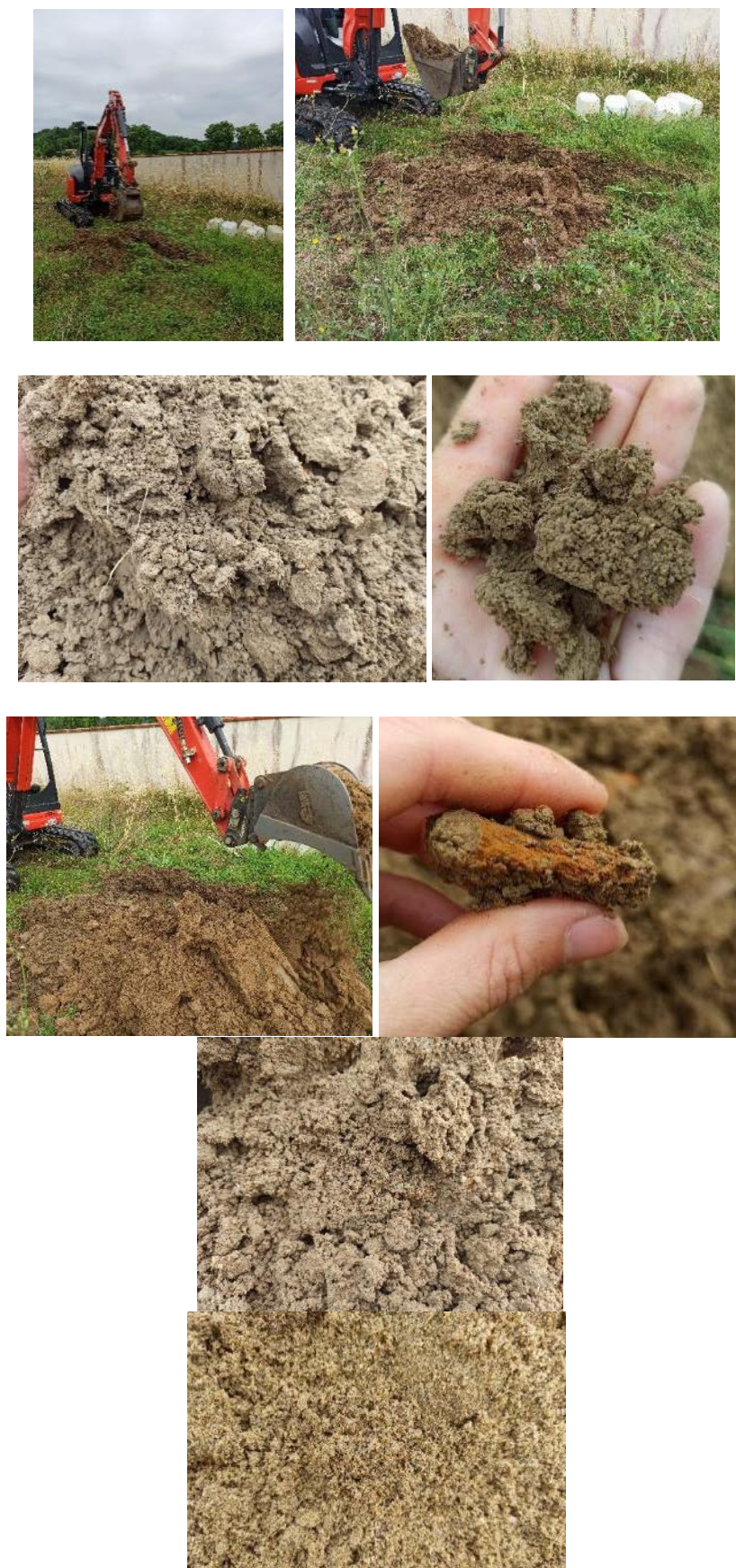
Figure 10 : Photographies de l'implantation du sondage PM1 et du sol rencontré au droit de celui-ci
