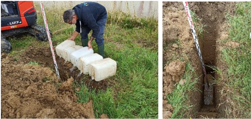
Figure 21 : Test MATSUO sur le sondage PM1
